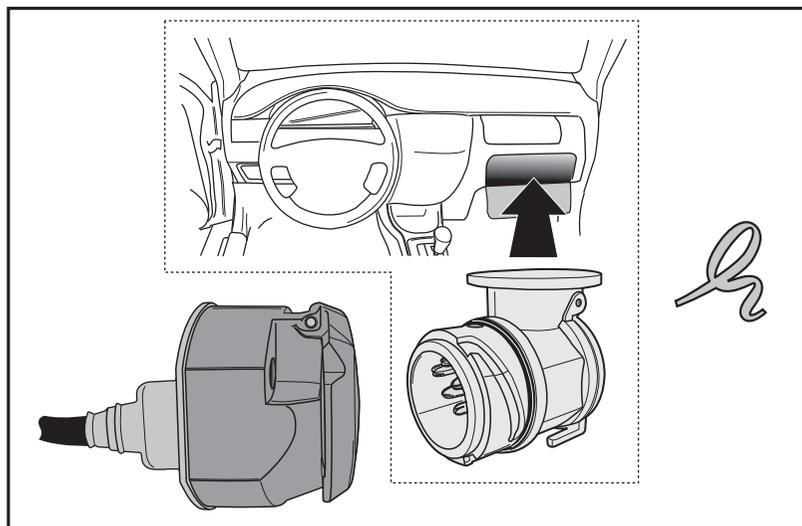
(DE) Die Blinklichter des Anhängers werden vom 5C021 Modul überwacht. Sollte eines der Anhängerblinklichter defekt sein, blinkt das Kontrolllämpchen am Armaturenbrett mit doppelter Geschwindigkeit auf. Kontrollieren Sie dann die Blinklichter des Anhängers.
